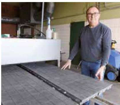
Omkring 500 kvadratmeter gulv kan blive vasket på over-og underside i timen.
