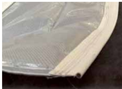
På isoleringsdugene er der monteret vulst lister, som kan trækkes gennem sporet på teltets ramme.
