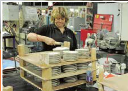
Med et lille luft sugende aggregat løftes hver tallerken op for at blive placeret et nyt sted og klar til næste tiltag.
