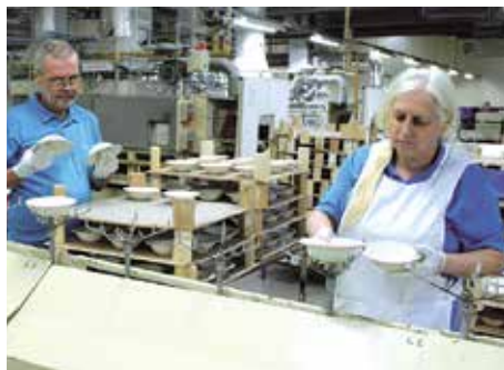
Dybe tallerkener sættes på et transportbånd, så der er mulighed for at påføre glasur på alle flader.
