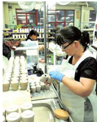
Hundredevis af keramiske dele bliver dagligt kontrolleret og pudset af med blødgjorte svampe i mange forskellige former.
