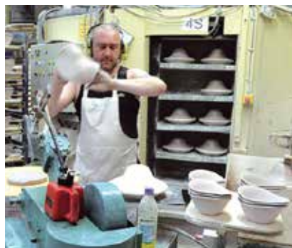
En lerkump flades ud, svinges i luften som pizzadej og ender med et klask på en form som presses og et nyt produkt er på vej.
