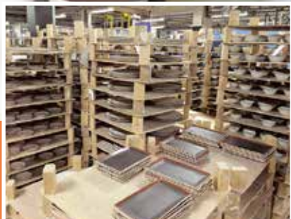
Masser af færdiglavede porcelænsvarer står hele tiden til tørre og venter på den næste proces.
