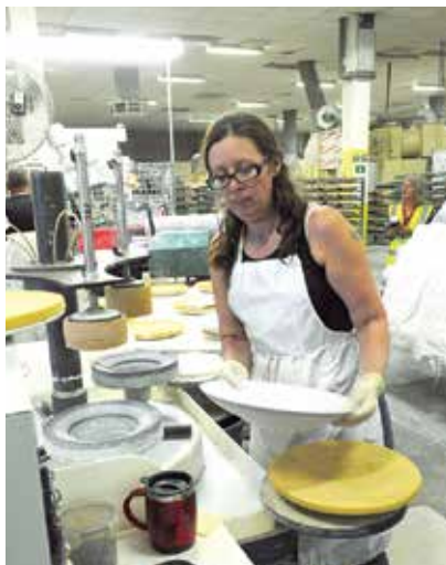
Tallerkener tjekkes og afpudses med svamp, så de er glatte og klar til at få påført glasur.
