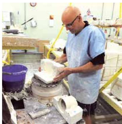
Kander laves ved at der sprøjtes flydende ler i forme, som derefter tørres, brændes, påføres glasur m.v.
