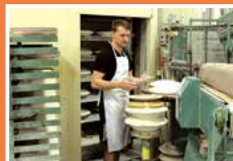
Lerklumpen til højre skæres i skiver, lægges på en form og presses til her at blive til en tallerken.
