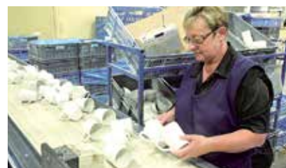
Alle krus klinkes mod hinanden. Lyden ved denne proces fortæller, om de er OK eller at de skal kasseres.
