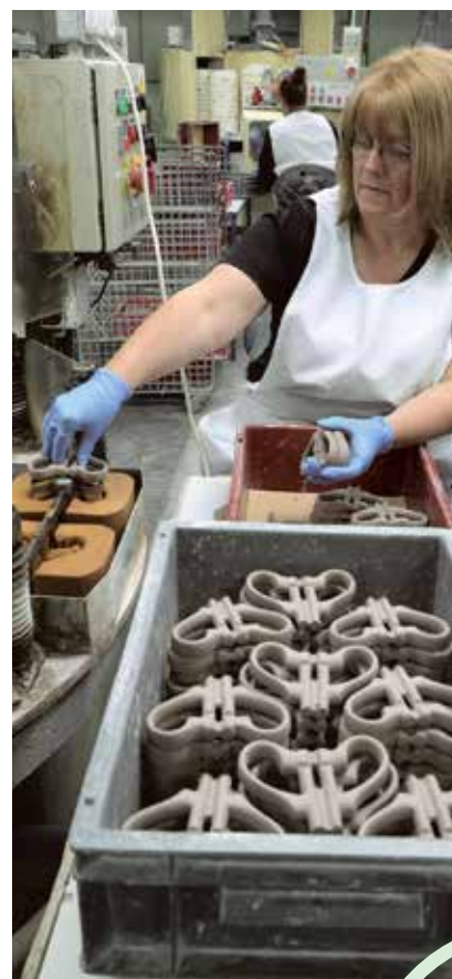
Ører til kopper og krus støbes og skilles ad, før de påmonteres.
