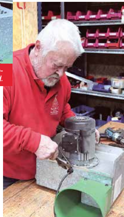
Der er en del forhindringer, der skal passes, inden at man når ind til blæserhjulet.
