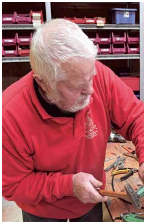
Det kan være nødvendigt at slå hovedet af popnitterne ved brug af en skruetrækker og hammer eller snitte dem af med en vinkelsliber.
