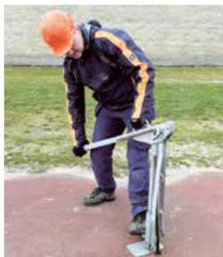
En selvkonstrueret pløkoptrækker sparer mange genvendigheder ved optrækningen.
