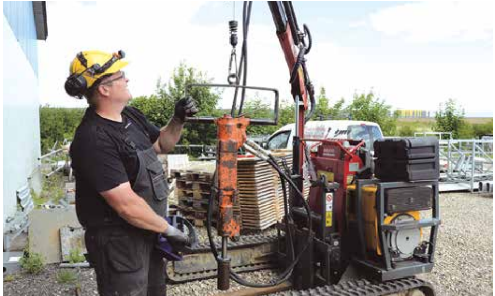
Maskinen laver al løftearbejdet og Mark Mikkelsen kan styre maskinen med trådløs sender.
