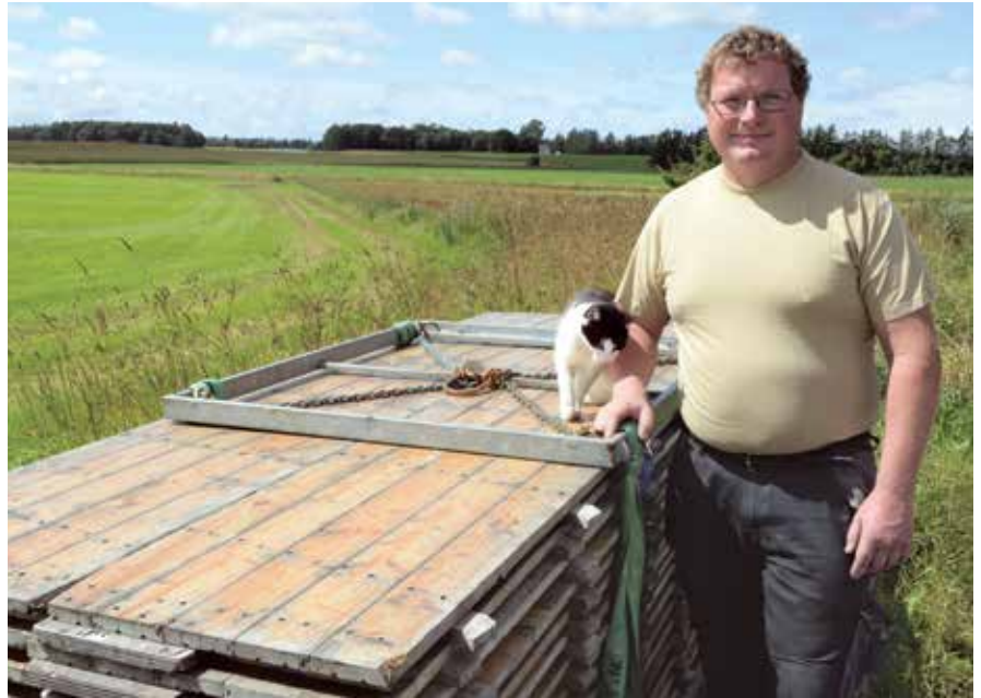
Gorm Andersen har lavet et specielt løfte åg til guldplader, så kanterne ikke bliver ødelagt, når de løftes.
