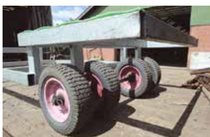
Med disse hjulsæt har Gorm Andersen udarbejdet en trækvogn, som let kan passere forhindringer som kantsten m.v.
