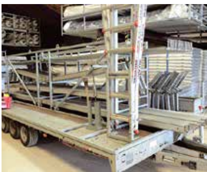
En specialindrettet trailer indeholder alt der skal bruges til en teltopstilling.
